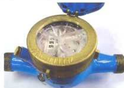
CONTATORE CON VETRO ROTTO A SEGUITO DELLA PROVA A PRESSIONE 32 BAR PER UN MINUTO
